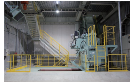
ギコチン式の cutter で粗大ごみを切断します。
