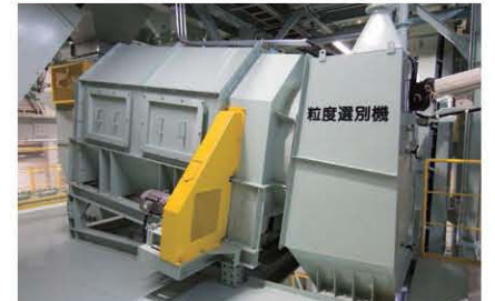
ふるい網のドラムが回転し不燃物を選別します。
