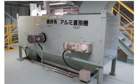
磁石ドラムが高速で回転することで発生する渦電流による磁界により、破砕物の中からアルミを選別します。
