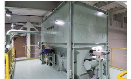
強力な磁石で破砕物の中から鉄分を選別します。
