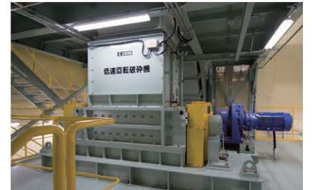
低速で回転する2つの cutter で粗大ごみ・不燃ごみをせん断します。
